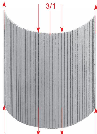
Teile vom Spritzling abtrennen und bei etwa 60 - 70 ° ca. 15 min. in den vorgeheizten Backofen legen. Teile vorsichtig biegen und mit Klebeband bis zur Auskühlung fixieren.
