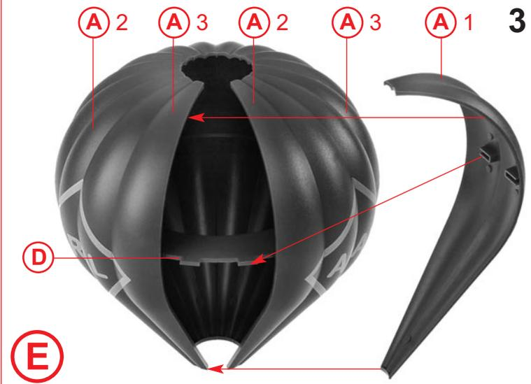
Sind alle Segmente der Ballonhülle zusammengefügt, ist es notwendig, die Hülle bis zum Abbinden des Klebers mit Hilfe eines Gummiringes zu fixieren.
