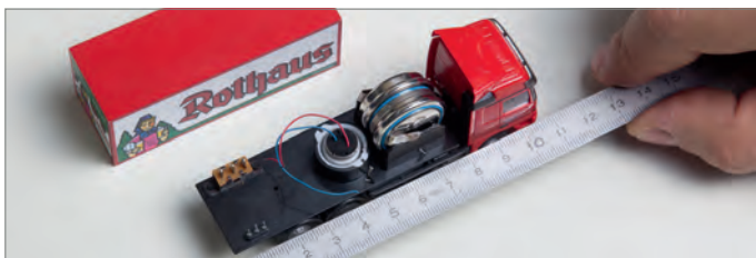
Abb. 32: Position der Ultraschallkapsel ermitteln: Abmessung am Fahrzeug
