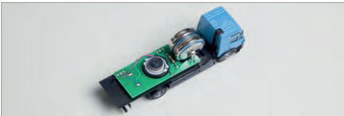
Abb. 9: Car System-LKW-Modell mit Universalplatine, gesteckte Akkus
