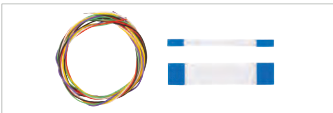
Abb. 3: Nutzen Sie die Flachbandkabel aus dem beiliegenden Set, um die Löt-, Digital- und Ultraschallplatine miteinander zu verbinden.
