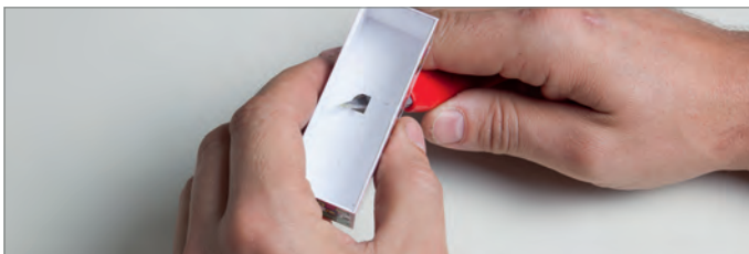
Abb. 36: Bohrung im Fahrzeugaufbau ausbessern
