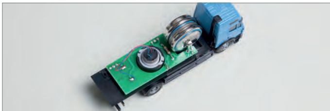
Abb. 28: LKW-Modell mit Universalplatine, gesteckte Akkus, mit Verkabelung
