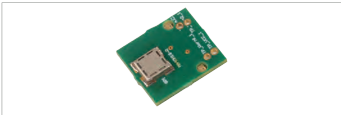
Abb. 2: Die Ultraschallplatine sendet Signale oberhalb des Hörfrequenzbereichs, die dem System zur Positionsmessung des Fahrzeugs dienen.
