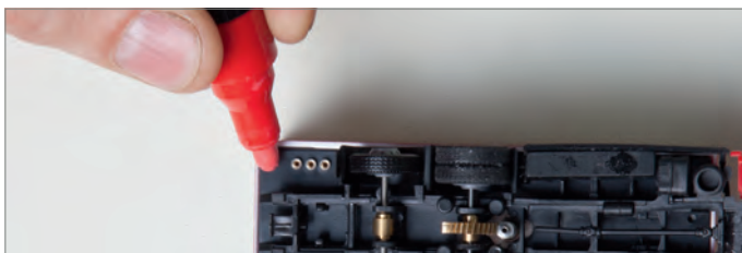
Abb. 10: Polung der Ladebuchse markieren, Fahrzeuggehäuse außen
