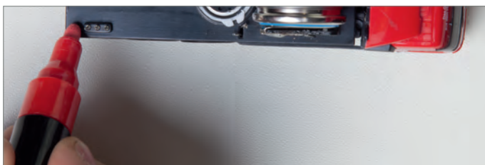
Abb. 11: Polung der Ladebuchse markieren, Fahrzeuggehäuse innen
