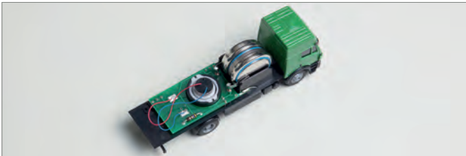
Abb. 8: Car System-LKW-Modell mit Universalplatine, gelötete Akkus
