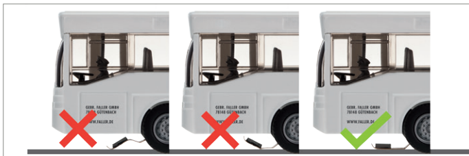
Abb. 51: Einstellung des Lenkschleifers
