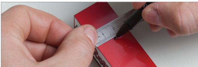
Abb. 36: Position der Ultraschallkapsel anzeichnen
