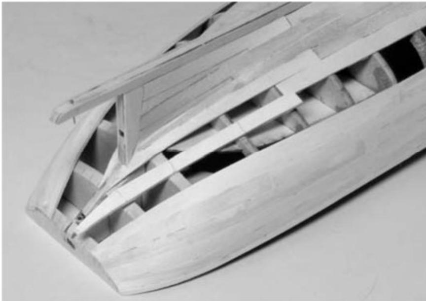
Foto 7: Die Form der Planken am Heck des Schiffes
