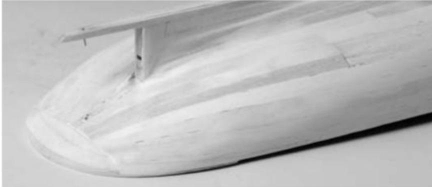
Foto 8: Das fertige Heck des Fächerschwanzes. Das Schleifen und Spachteln hat begonnen
